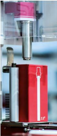
Der Einsatz des mit viermal mehr Sorbens ausgestatteten neuen Dynamic-Headspace-Systems 3.5 (DHS 3.5) verbessert die Wiederfindung flüchtiger organischer Verbindungen (VOC) gegenüber Standard-DHS. Einsetzen lassen sich 3,5-Zoll-Sorptionsröhrchen, beladen mit beispielsweise bis zu 240 mg Tenax TA. Die bessere Wiederfindung zieht eine höhere Genauigkeit sowie niedrigere Bestimmungsgrenzen beim Nachweis sehr flüchtiger Stoffe (VOC) nach sich. Die Temperatur des
