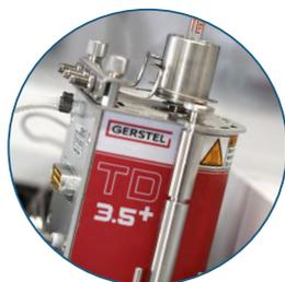
gruppen konfiguriert werden, eine Falle reicht für alle Fälle: Der Vollständigkeit halber: Die kühlmittelfreie Kryostatenkühlung erlaubt Temperaturen bis minus 40 °C, die Peltier-Kühlung reicht bis plus 10 °C; eine moderate Temperatur, die geeignet ist zum Anreichern und Fokussieren von Hochsiedern.
